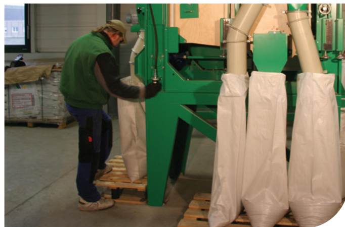
Trieur - Séparateur haute performance avec récupération de 99% de pureté des semences
